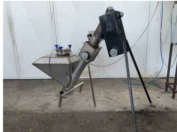
Figure 1: Vergaser für Solarkohle, Wärmeleistung 25 kW.
